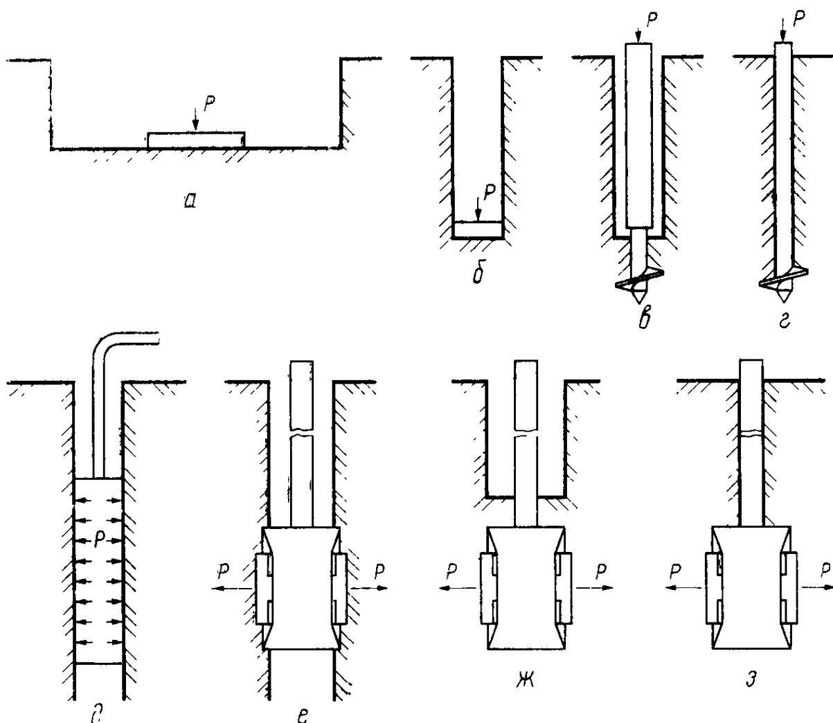
а—плоским штампом в шурфе или дудке; б—плоским штампом в забое буровой скважины; в—винтовым штампом ниже забоя буровой скважины; г—винтовым штампом в массиве; д—радиальным прессиометром; е—лопастным прессиометром в стенке скважины; ж—лопастным прессиометром ниже забоя буровой скважины; з—лопастным прессиометром в массиве
