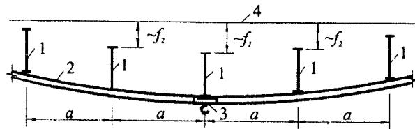
1 – стропильные конструкции; 2 – балка подвесного кранового пути; 3 – подвесной кран; 4 – исходное положение стропильных конструкций;  $f_1$  – прогиб наиболее нагруженной стропильной конструкции;  $f_2$  – прогибы смежных с наиболее нагруженной стропильными конструкциями
